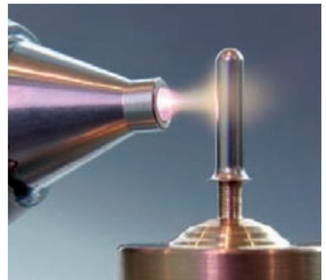
Abb. 7: Brillante Oberflächen werden im Automobilbau durch eine Vorbehandlung mit atmosphärischem Plasma vor dem Lackieren erreicht. (Foto: Plasmatreating)
