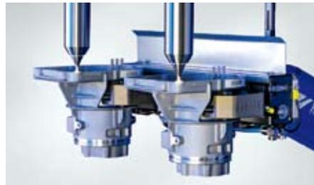
Vor der Plasmabeschichtung werden die TRW Motor-Pumpengehäuse mit Openair Plasma mikrofein vorgereinigt Foto: Plasmamatreat
