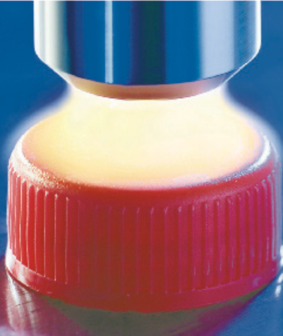
Abb. 1: Zur Vermeidung von Haftungsproblemen wird die Kunststoffoberfläche vor dem Bedrucken mit »Openair«-Plasma feinstgereinigt und ihre Oberflächenenergie erhöht. Fotos und Grafik: Plasmareat.
