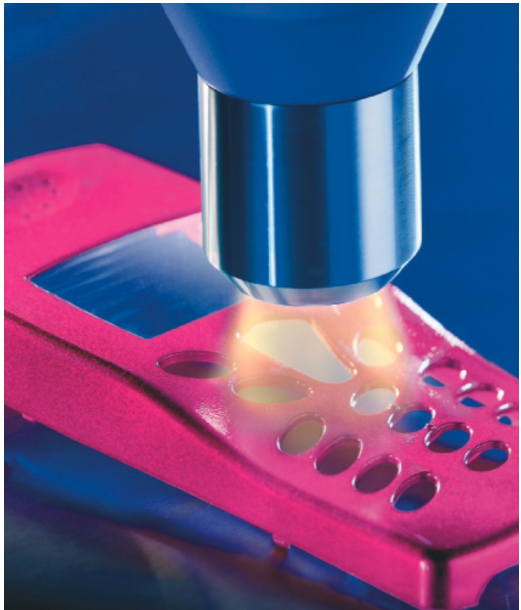
Abb. 6: Nicht sichtbare Feinststäube führen zu Unansehnlichkeiten bei der Lackierung. Die Plasmabehandlung sorgt für ein makelloses Lackbild.
