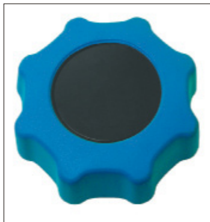
Abb. 4: Innovative Lösung: Erst durch die Vorbehandlung mit »Openair«-Plasma wird der feste Verbund eines harten Polypropylens (innen) und einer weichen, griffigen TPU-Spritzguss-Ummantelung möglich. Das 2K-Verstellrad wurde bei Müller Technik als Versuchsbauteil hergestellt.
