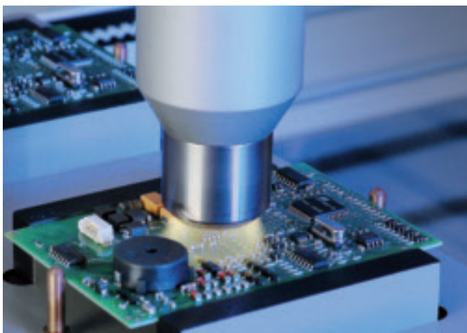
Abb. 6: Plasmatreteat: Zur langfristigen Haftung des Hotmelts erfolgt vor dem Verguss die mikrofeine Reinigung und Aktivierung der Platine mittels atmosphärischem Plasma
