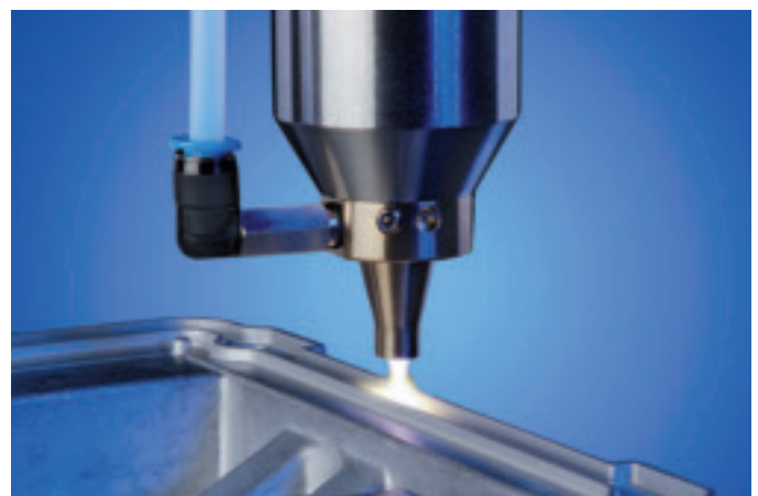
Abb. 1: Zur Nanobeschichtung eines Elektronikgehäuses im Openair-PlasmaPlus Verfahren wird dem Plasma eine siliziumorganische Verbindung zugeführt.
