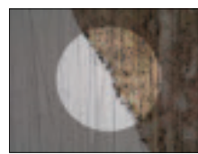
Abb. 5: Plasmateat: Die mikroskopische Aufnahme zeigt: der mit der PlasmaPlus Schicht geschützte Bereich (links) zeigt auch nach Einwirkung von 96 h Salzsprüh-test keine Anzeichen von Korrosion.
