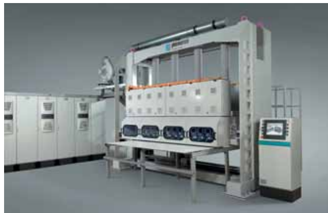
BILD 6 Für große Behandlungsbreiten und einen hohen Durchsatz wurde die neue Inline-Plasma-Paneelanlage konzipiert
