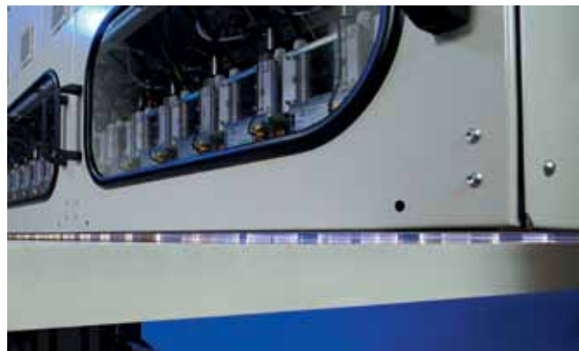
BILD 7 28 Rotationsdüsen mit einer Behandlungsbreite von je 100 mm wurden in zwei Reihen hintereinander versetzt angeordnet. Platten bis zu 3 m Breite können hiermit feinstgereinigt und aktiviert werden (alle Abbildungen: Plasmatreat)
